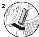
Gatilho desbloqueado (a pistola pulveriza)
