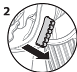
Gatillo desbloqueado (la pistola sí pulveriza)
